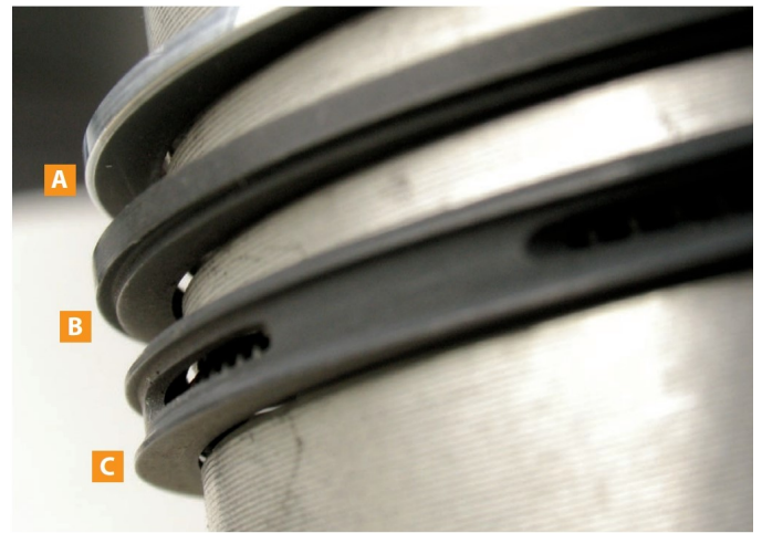
Powyżej – nowy tłok i pierścienie. Widać prawidłowy profil pierścienia górnego (A) i ostre krawędzie pierścienia zgarniającego (B) oraz olejowego (C). Poniżej – pierścienie częściowo zużyte, ale jeszcze w dobrym stanie.
